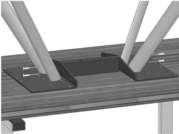
5. Die Stahl Platten mit dem Holzsteg verbinden.
